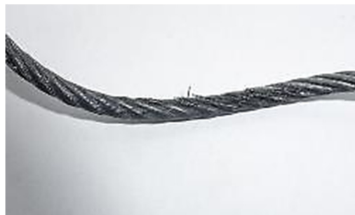
Abbildung 6: Beschädigtes Steuerseil im Bereich der Umlenkrolle vorne oben links
