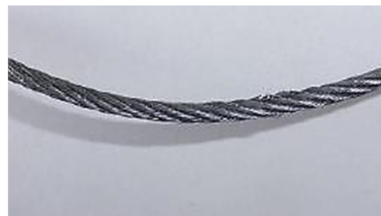
Abbildung 7: Beschädigtes Steuerseil im Bereich der Umlenkrolle vorne oben rechts
