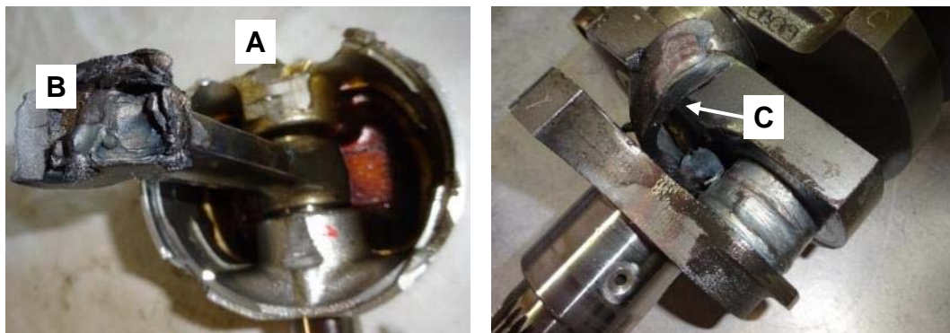
Abbildung 7: Links: Kolben des Zylinders Nr. 1 mit abgebrochenen Randpartien (z. B. bei A) und Reste des defekten Pleuellagers (B). Rechts: Mit Kurbelwelle verschweisstes Lager und Reststück (C) des Pleuels des Zylinders Nr. 1.
