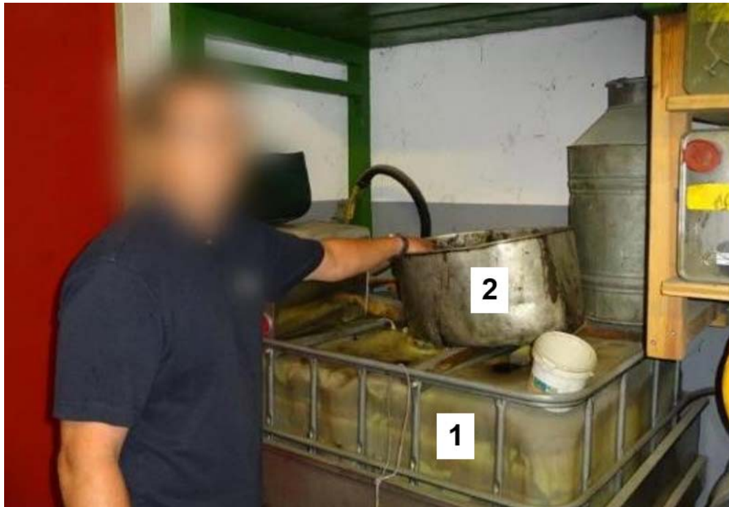
Abbildung 9: Zu erkennen sind der grosse Altölbehälter (1) und der Trichter (2), in den der Ölbehälter der HB-SRB zwecks dessen Reinigung entleert wurde. Die Oberkante des Trichters reicht knapp unter Schulterhöhe. Die Aufnahme entstand nach dem Unfall.
