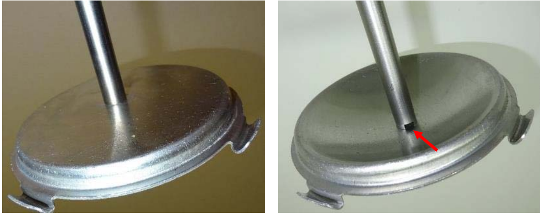
Abbildung 10: Links: Zwischenwand und Ansaugrohr des Ölbehälters des Motors 912 vor der Vereinheitlichung der Ölbehälter. Rechts: Zwischenwand und Ansaugrohr des Ölbehälters nach der Vereinheitlichung der Ölbehälter (roter Pfeil zeigt Schlitzkontur).
