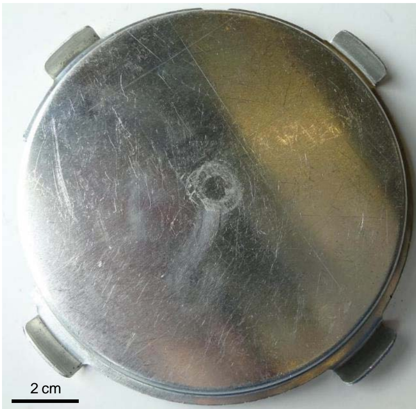
Abbildung 6: Das Muster kreisförmiger Kratzspuren mittig auf der Zwischenwand.
