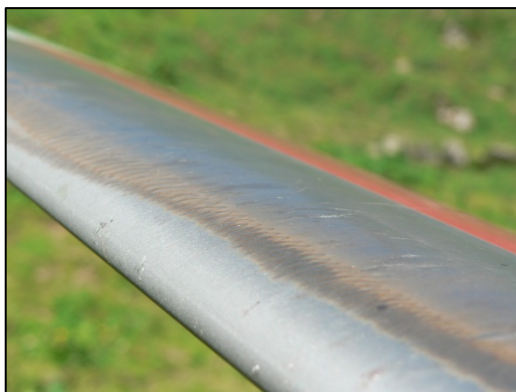
Abbildung 7: Spuren an der Eintrittskante und der Oberseite eines Hauptrotorblattes
