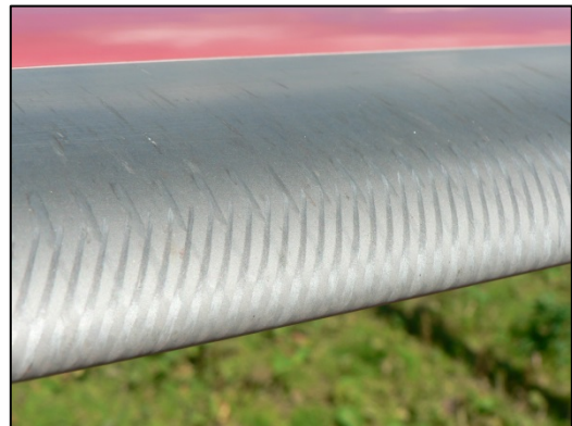
Abbildung 6: Spuren an der Eintrittskante eines Hauptrotorblattes
