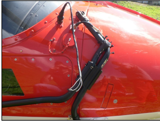
Abbildung 3: Abgerissener elektrisch verstellbarer Spiegel
