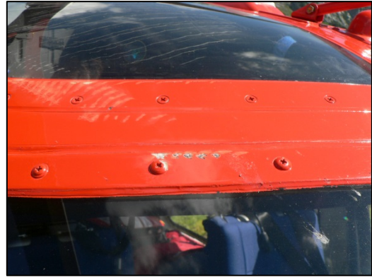
Abbildung 4: Spuren im Bereich des rechten oberen Deckenfensters
