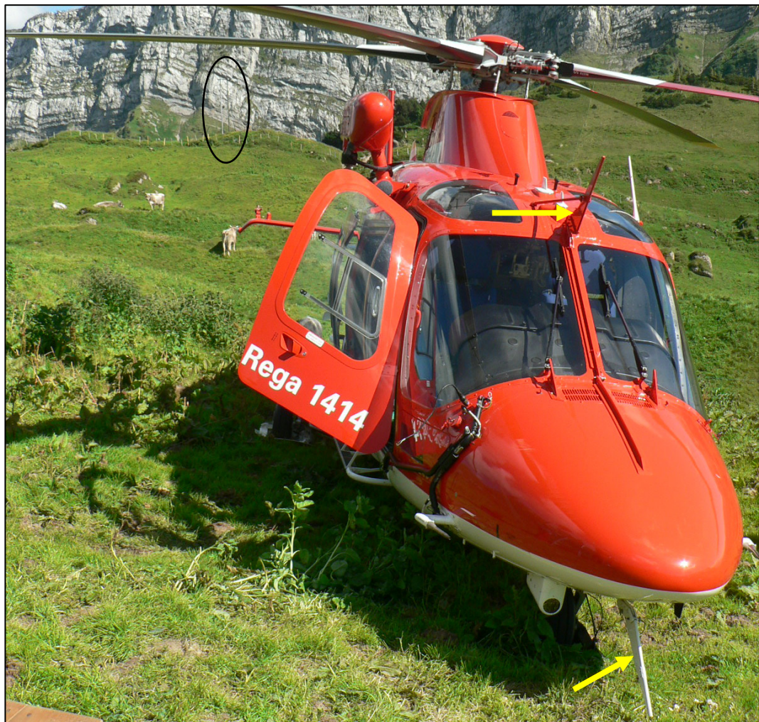
Abbildung 9: Frontansicht der HB-ZRY an der Stelle, wo der Helikopter nach dem Unfall gelandet wurde. Gut sichtbar sind der lower und der upper cutter des Kabelkappsystems (gelbe Pfeile). Die Telefonleitung, mit der die HB-ZRY kollidierte, führte vom Mast bei der Hütte (vgl. Position ① in Abbildung 2) zum nächstgelegenen Mast auf einer Kuppe (schwarz eingekreist).
