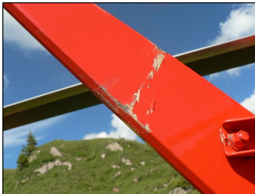
Abbildung 5: Spuren am upper cutter des Kabelkappsystems
