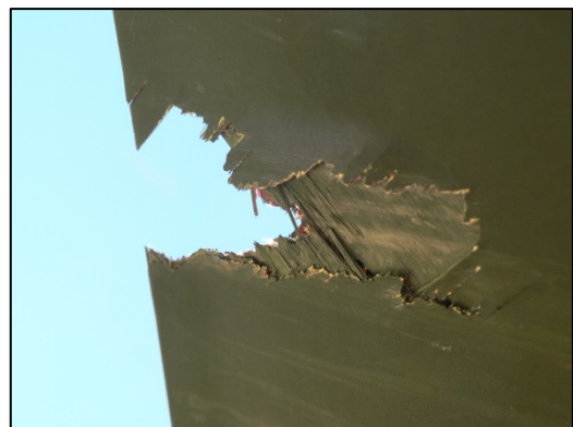
Abbildung 8: Schaden an der Austrittskante eines Hauptrotorblattes
