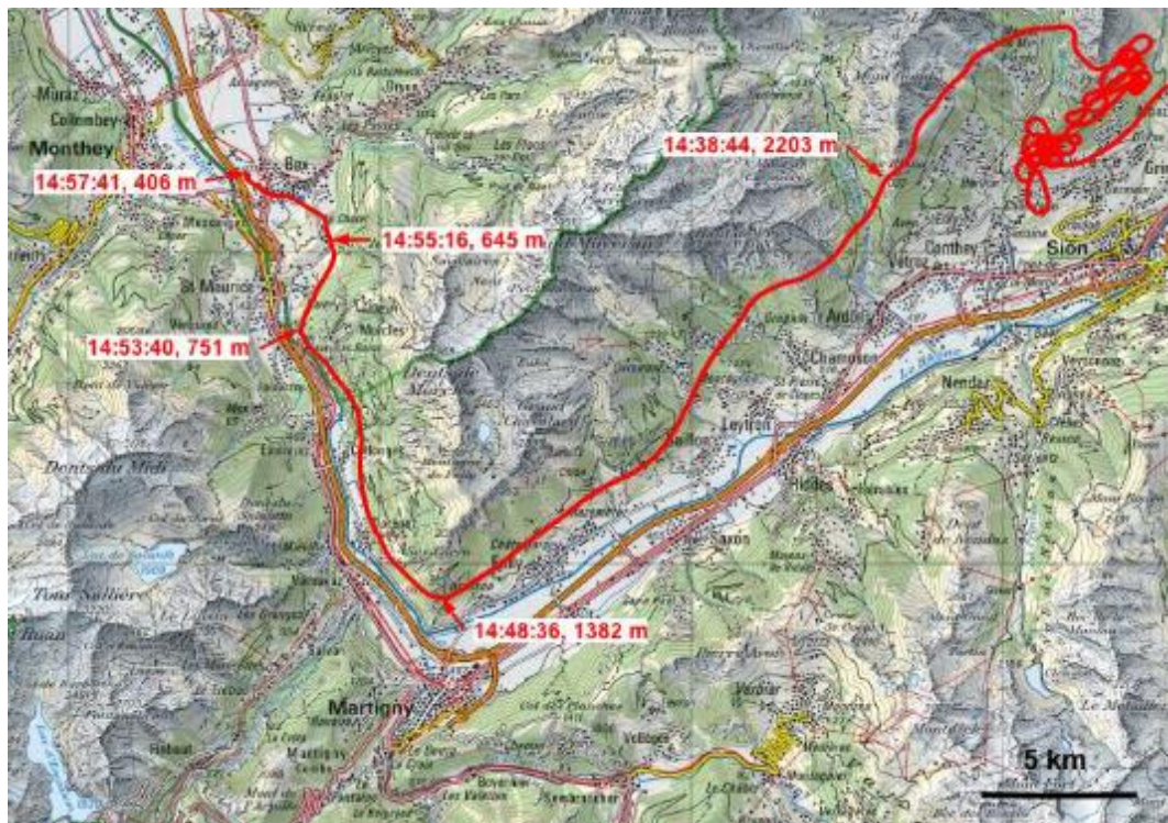
Figure 1 : Trajectographie du motoplaneur HB-2483 (en rouge) après la rentrée du moteur d'appoint. Les flèches étiquetées des données de temps et d'altitude en mètres au-dessus du niveau de la mer indiquent des points distincts du vol; carte reproduite avec l'autorisation de l'Office fédéral de la topographie Swisstopo (JA 150149).
