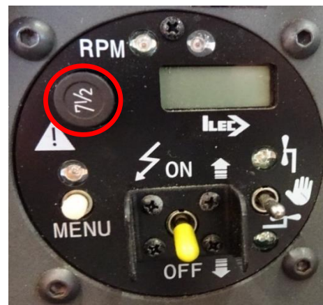
Figure 5 : unité de commande du moteur d'appoint avec le coupe-circuit principal (cercle rouge)
