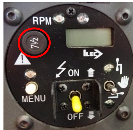
Abbildung 5: Bedieneinheit mit Hauptsicherung (roter Kreis)
