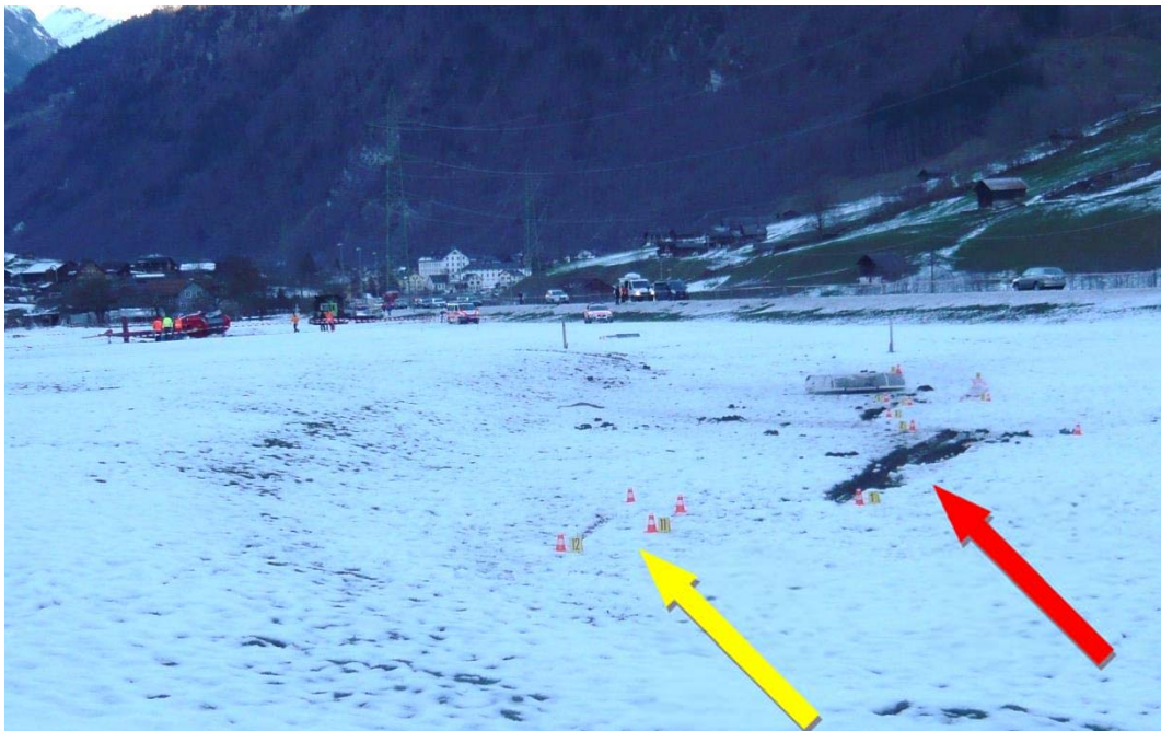
Abbildung 3: Erste Aufprallspuren von der rechten Kufe am Boden (roter Pfeil) und Spuren im Schnee vom Hecksporn bzw. den Blattenden des Heckrotors (gelber Pfeil). Endposition des Skikorbens und Endlage des Helikopters (Aufnahme vom Unfalltag).
