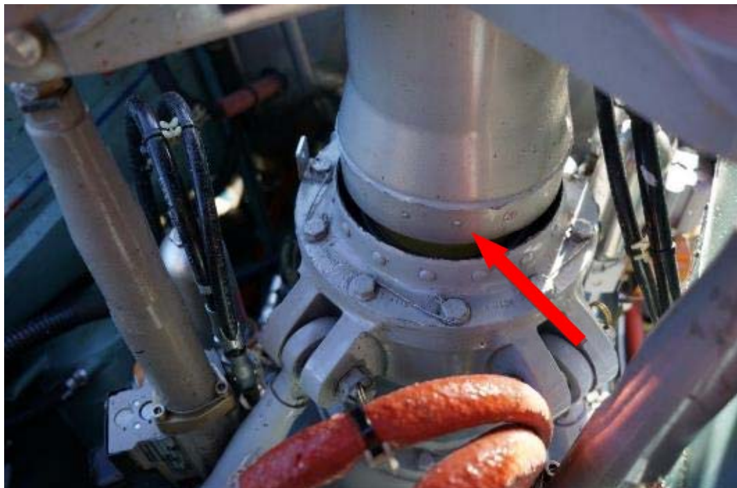
Abbildung 4: Swashplate guide , die aus ihrer Befestigung am oberen Teil des Hauptgetriebegehäuses gerissen war (roter Pfeil).
