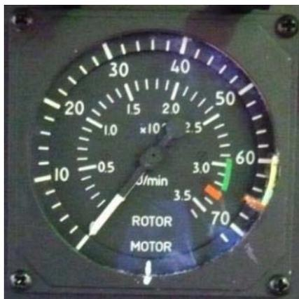
**Abbildung 3:** Das Cockpitinstrument zeigt im inneren Kreis die Drehzahl des Rotors und im äusseren Kreis die Drehzahl der Arbeitsturbine an.
