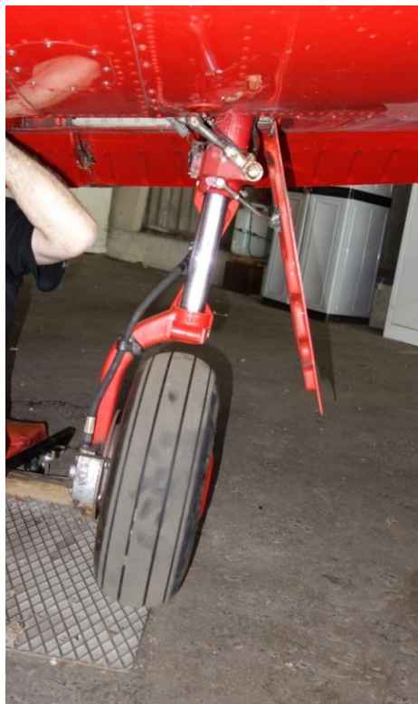
Abbildung 7: Linkes Hauptfahrwerk der aufgebockten HB-PLC in nicht vollständig ausgefahrener Position
