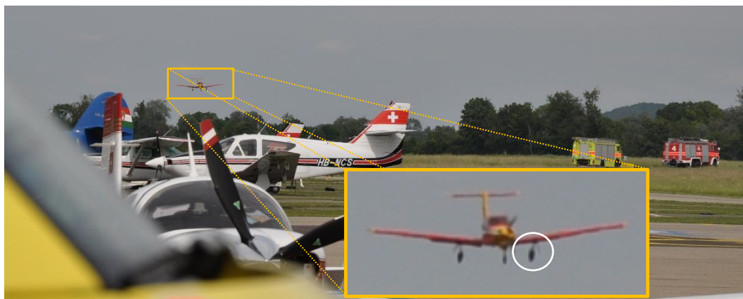
Abbildung 1: Die HB-PLC im Endanflug auf die Hartbelagpiste 25 des Regionalflugplatzes Grenchen (LSZG) mit nicht vollständig ausgefahrenem Fahrwerk (weisser Kreis).
