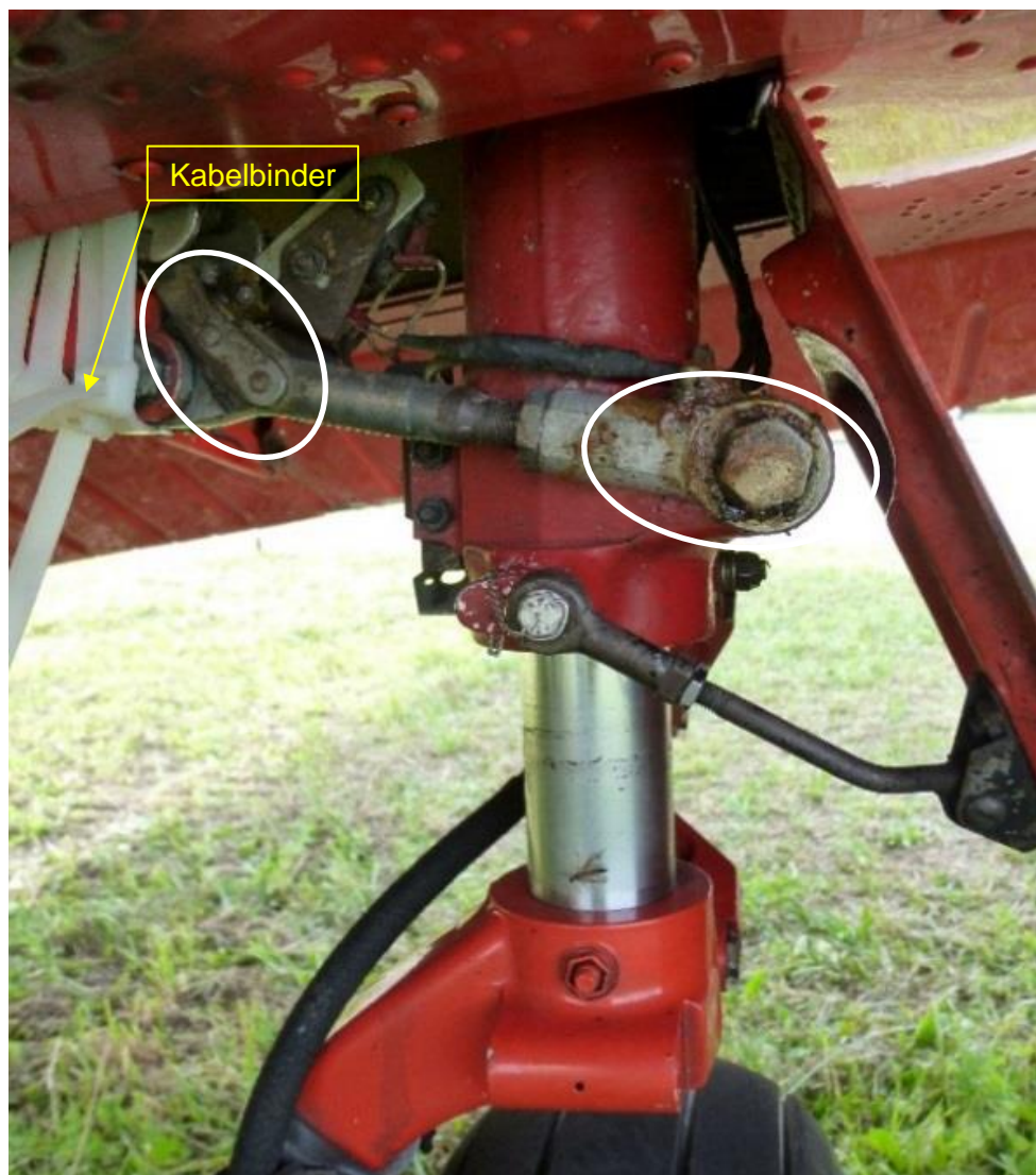
Abbildung 6: Linkes Hauptfahrwerk der HB-PLC mit Kabelbindern (gelber Pfeil) und deutlichen Fettspuren auf der Aussenseite des Fahrwerkgestänges (weiss eingekreist)
