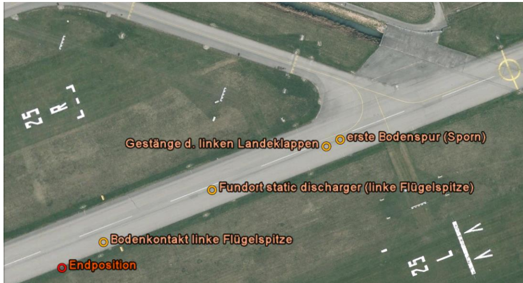
Abbildung 4: Endposition der HB-PLC (rot) sowie markante Merkmale der Schleifspur, die von der Landung der HB-PLC auf Piste 25 herstemten.
