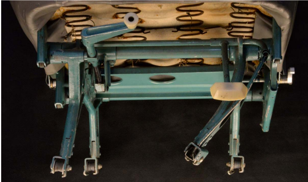
Abbildung 5: Pilotensitz mit verbogenen Sitzbeinen (von vorne gesehen)
