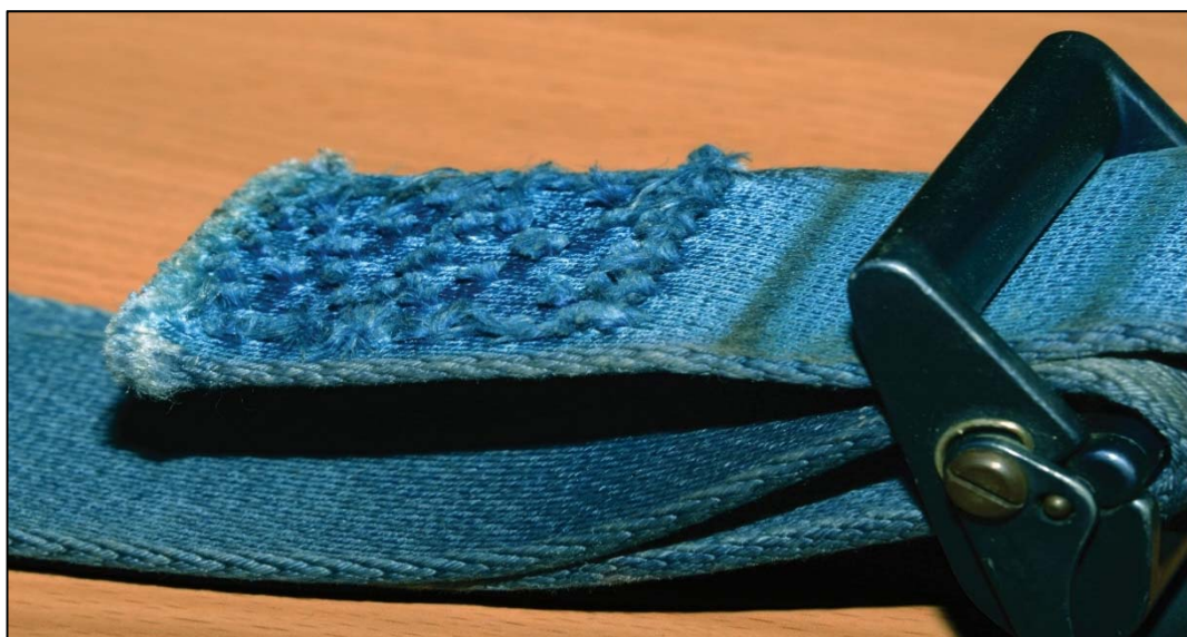
Figura 8: frammenti di fili rotti
