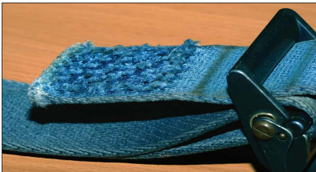
Figure 8 : fragments de fils rompus.
