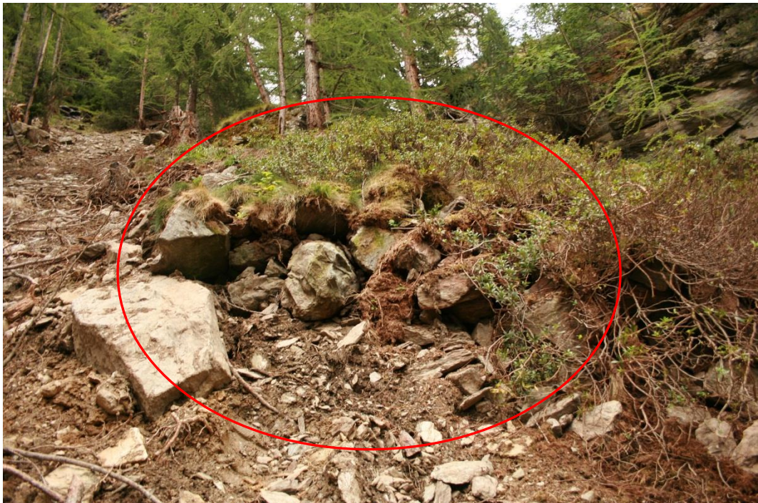
Abbildung 5: Bodenbeschaffenheit an der Stelle (rot markierter Bereich), wo die Baumgruppe stand. Die spärlich bewachsene Humusschicht war ungefähr 10 cm stark. Darunter beginnt eine Schicht, die vornehmlich aus Steinen und Geröll besteht.
