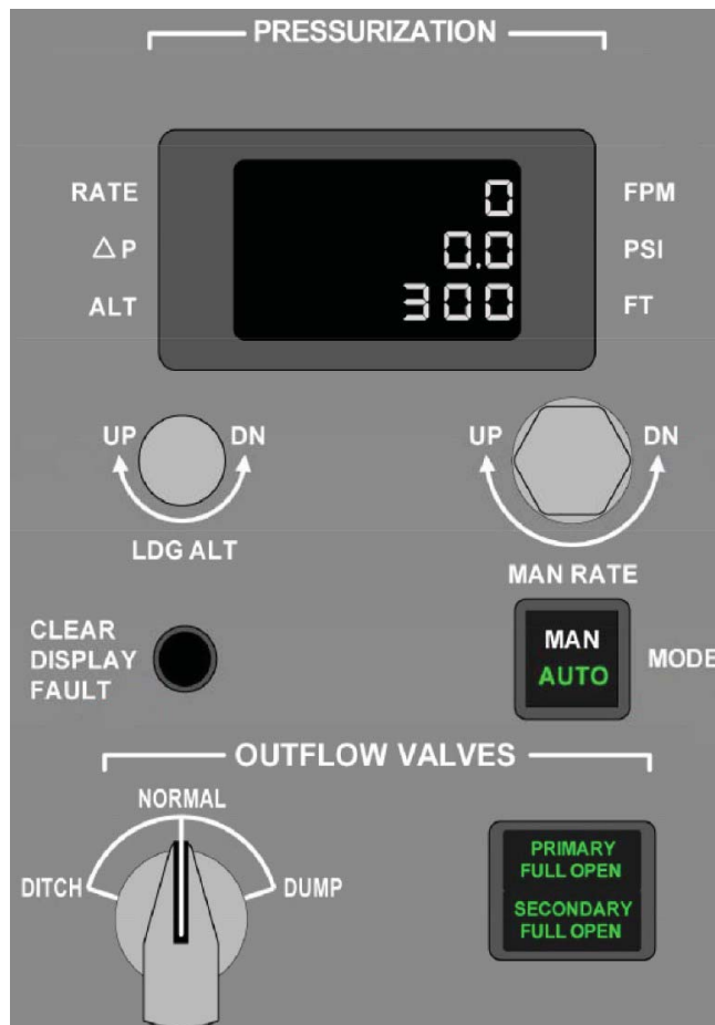
Figure 2: régulateur de pressurisation cabine CPC
