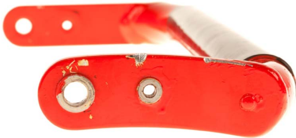
Abbildung 3: Haltebügel mit dem beschädigten seitlichen Flachprofil (Detail siehe Abb. 4).
