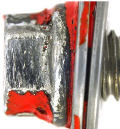
Abbildung 5: Detail der beschädigten Mutter (Pos. 29) und Unterlegscheibe (Pos. 28).
