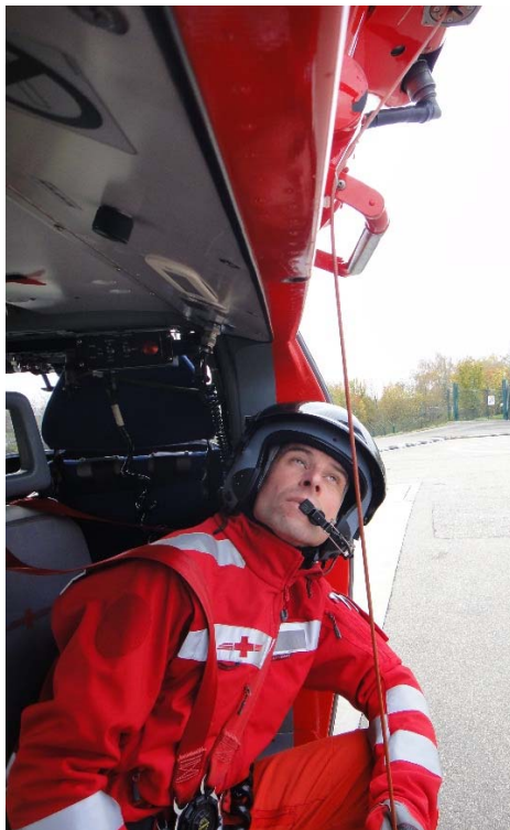
Abbildung 10: Notwendige Arbeitsposition des WOP, um ein möglicherweise verfangenes Windenseil erkennen zu können.
