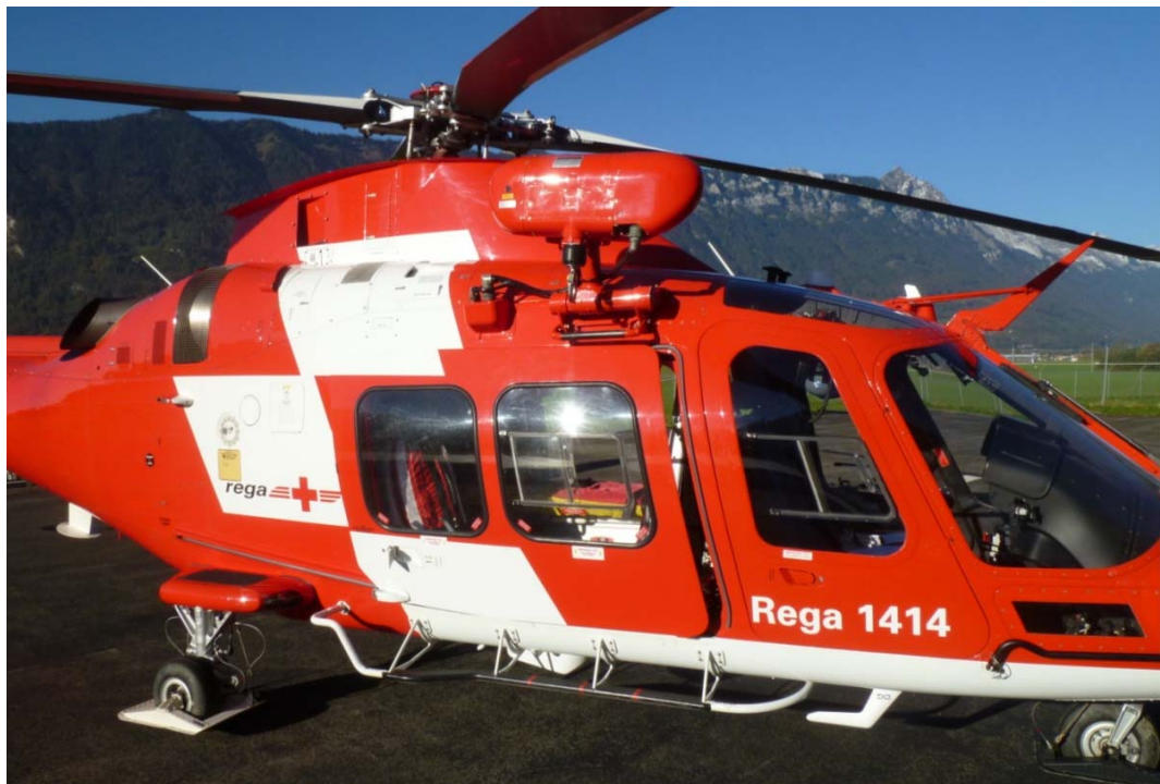
Abbildung 1: Übersicht der Installation der Rettungswinde. Die Aufnahme stammt von einem baugleichen Muster.
