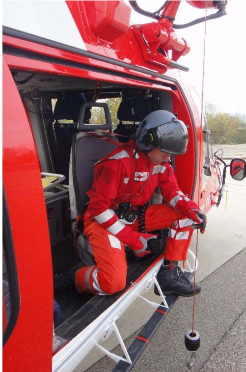
Abbildung 8: Arbeitssituation des WOP bei normaler Seillage. Der WOP richtet seinen Blick hauptsächlich nach unten, um die Rettungswindenaktion durchzuführen.
