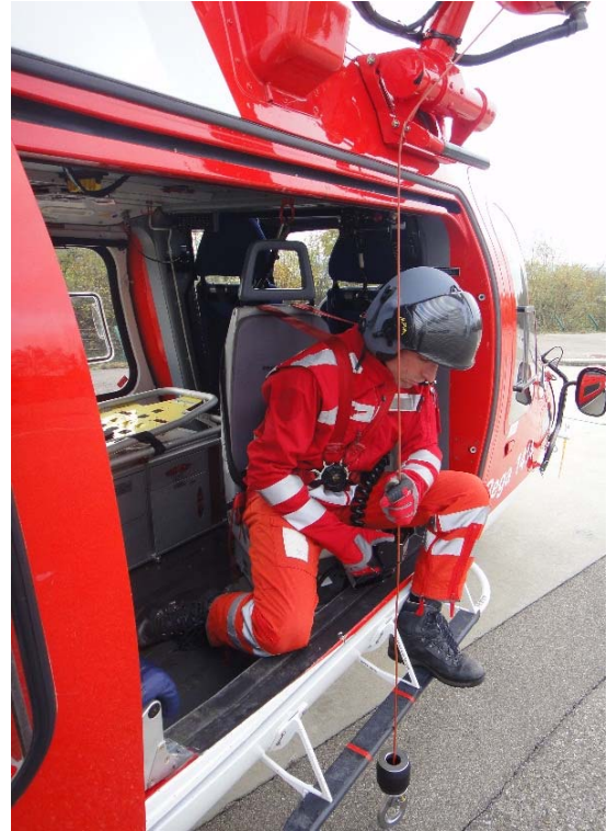
Abbildung 9: Arbeitssituation des WOP bei verfangener Seillage. Das Seil verläuft gegenüber der normalen Seillage näher an der Trittstange.
