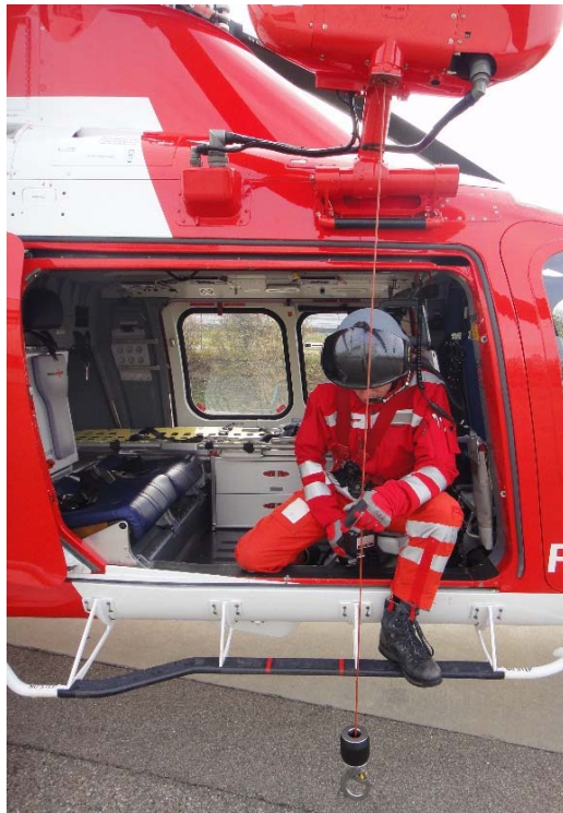
Abbildung 6: Arbeitssituation des WOP bei normaler Seillage. Die roten Markierungen auf der Trittstange ( step bar ) zeigen die Begrenzungen für die longitudinale Position des Windenseils an. Sie wurden nach einem Vorfall aufgrund einer airworthiness directive (AD), die nicht in Zusammenhang mit dem vorliegenden Fall steht, angebracht.
