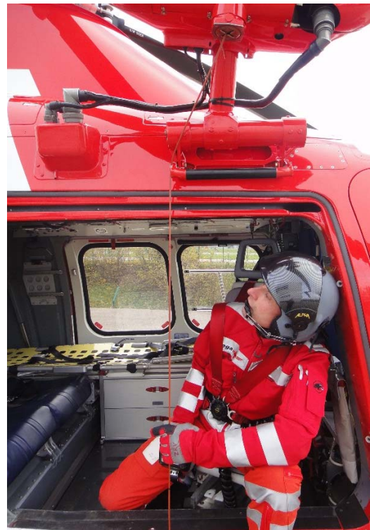
Abbildung 11: Der WOP muss sich bis unter den oberen Türrahmen nach vorne lehnen, damit er die Rettungswinde sehen kann.
