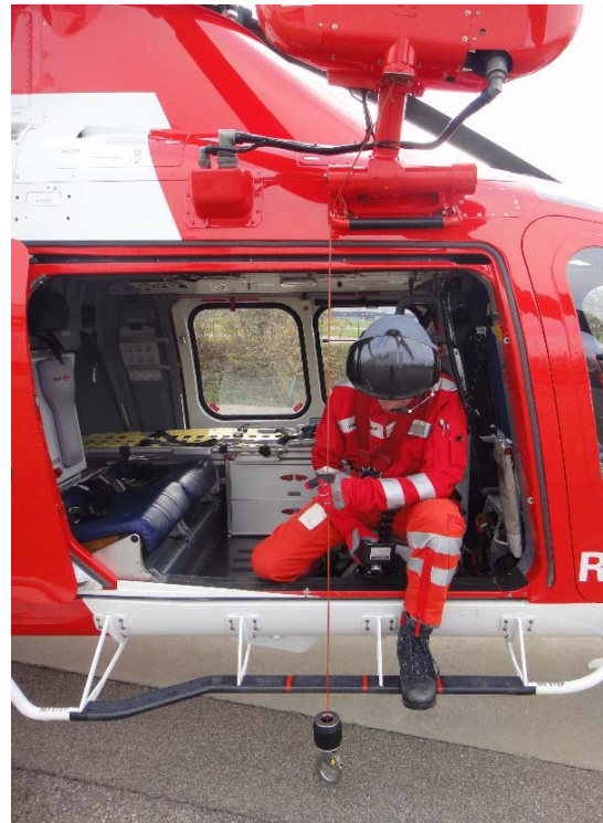
Abbildung 7: Arbeitssituation des WOP bei verfangener Seillage. Der seitliche Seilver-satz gegenüber der normalen Seillage beträgt rund 15 cm.
