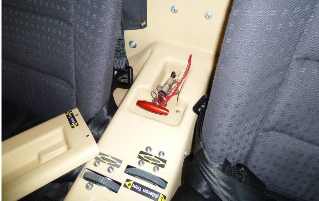
Figure 6 : Poignée de déclenchement du système de sauvetage, située dans le cockpit, avec la goupille de sécurité mise en place
