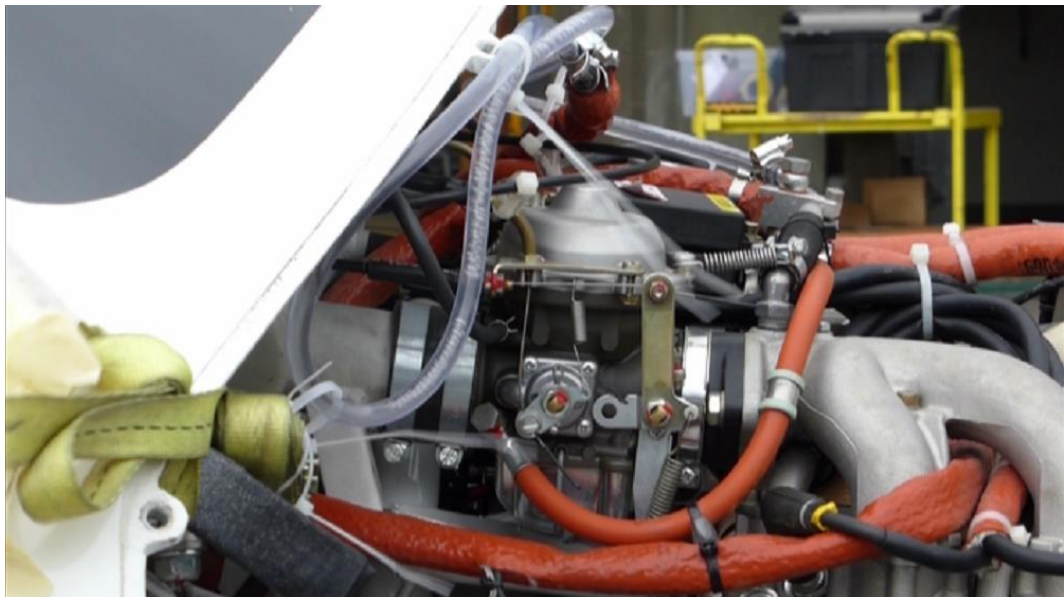
Figure 9 : Bulles d'air dans le tuyau en plastique transparent de la conduite de retour de carburant
