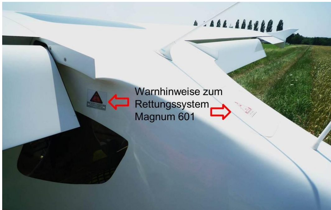
Abbildung 5: Warnhinweise zum Rettungssystem Magnum 601 am Rumpf
