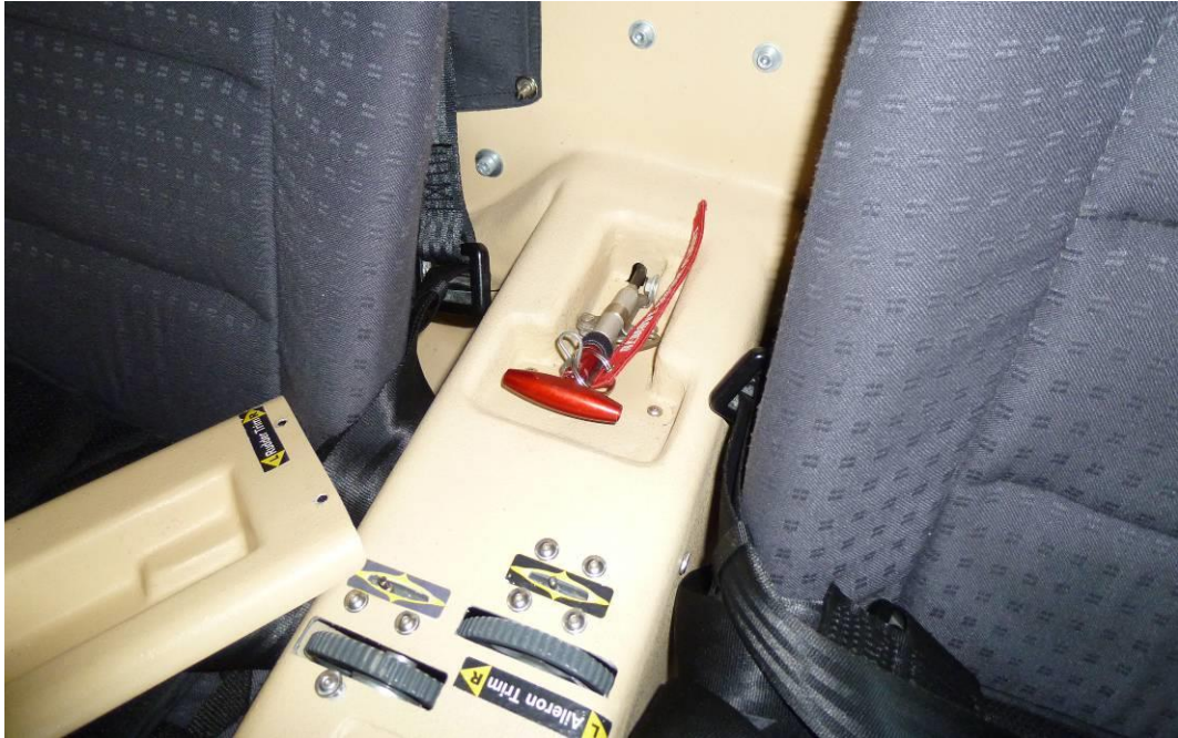
Abbildung 6: Auslösegriff des Rettungssystems im Cockpit mit eingesetzter Sicherungsnadel
