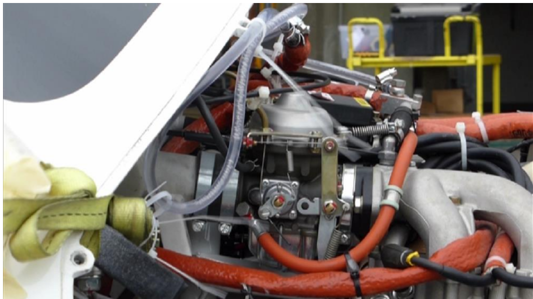
Abbildung 9: Gasblasen im transparenten Kunststoffleitungsstück der Kraftstoffrücklaufleitung
