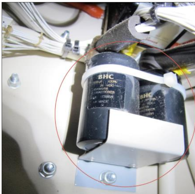
Figure 2 : condensateurs installés dans le cockpit d'un avion Tecnam P2002-JF similaire au HB-KPB.
