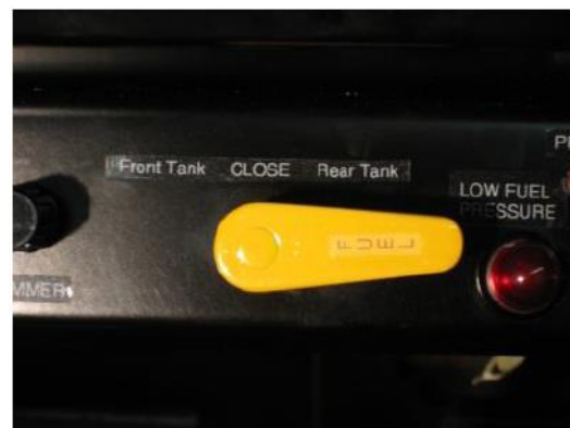
Abbildung 5: Tankwählhahn der HB-SEW in Stellung „Rear Tank“
