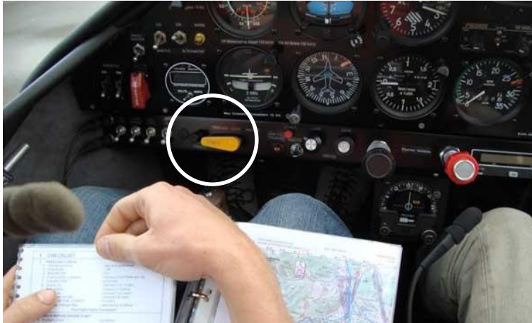
Abbildung 3: Cockpit der Jodel „Sicile“ DR1050 HB-SEW mit Tankwählhahn (gelb) auf dem Instrumentenbrett
