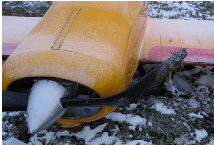
Abbildung 8: Zurückgebogenes Propellerblatt der HB-SUV
