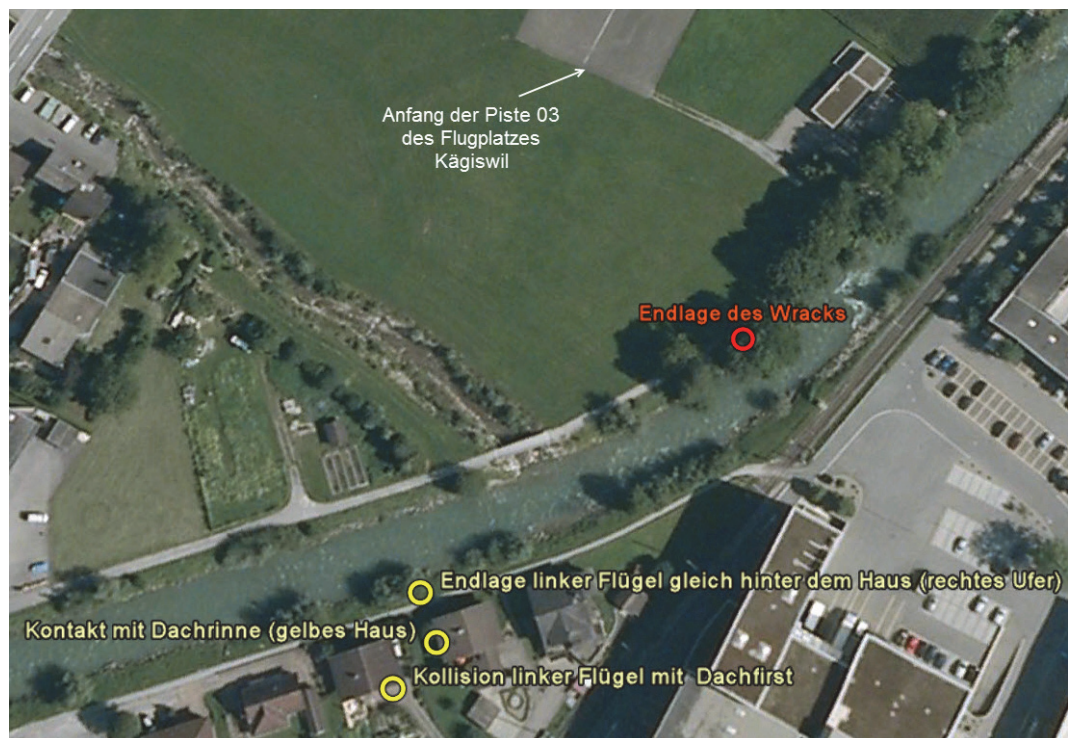
Abbildung 4: Darstellung der ersten Aufschlagstelle sowie der Endlage des linken Flügels und des Hauptwracks der HB-3410 in Google Earth.
