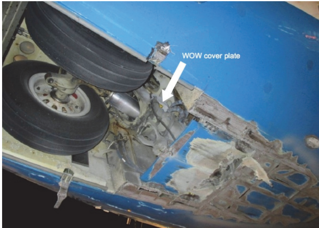
Abbildung 7: Die im Mechanismus des Bugfahrwerks eingeklemmte WOW cover plate . Diese Aufnahme wurde noch auf der Unfallstelle aufgenommen.
