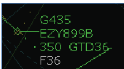
Figure 8 : EZY 899B est en contact avec le secteur L5. Il a reçu l'autorisation de monter au FL 360 (F36). La manipulation close the loop par le contrôleur RP n'est pas encore effectuée (F36 en blanc). Lorsqu'elle le sera, « F36 » deviendra vert
