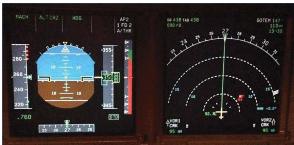
Figure 10 : visualisation en place gauche d'un avis de résolution « climb » sur les PFD et ND de l'A320
