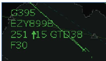
Figure 6 : EZY 899B est en contact avec un secteur en dessous du secteur L5. Il est autorisé à monter au FL 300 (F30)
