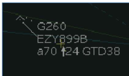
Figure 5 : l'étiquette d'EZY 899B après corrélation. L'ATM a associé les données du plan de vol et les informations transmises par le transpondeur de l'avion. Son altitude actuelle est 7000 ft (a70) et l'ATM lui a attribué le niveau de croisière demandé FL 380 (38)
