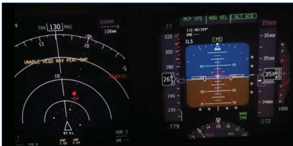
Figure 11 : visualisation en place droite d'un avis de résolution « climb » sur les PFD et ND du Boeing 737-800
