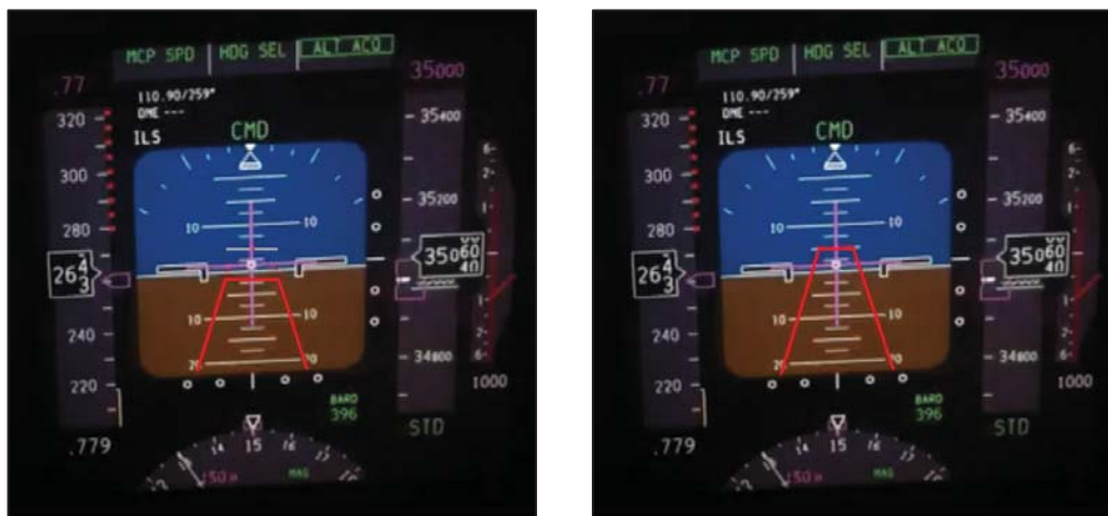
Figure 18 : avis de résolution préventif « monitor vertical speed » à gauche et correctif « climb, climb » à droite
