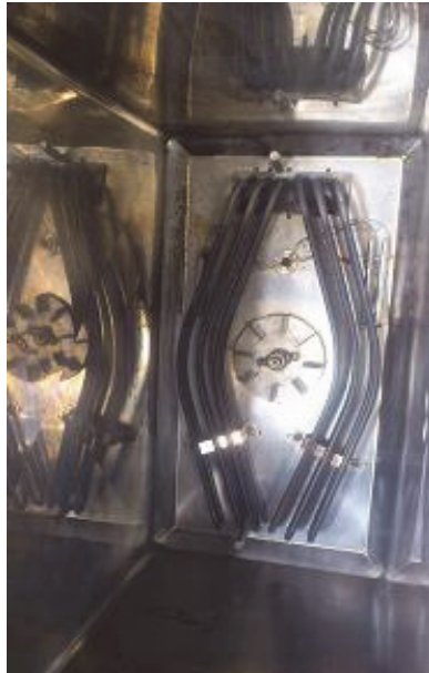
Abbildung 4: Ofen mit ungeschütztem Heizelement.
