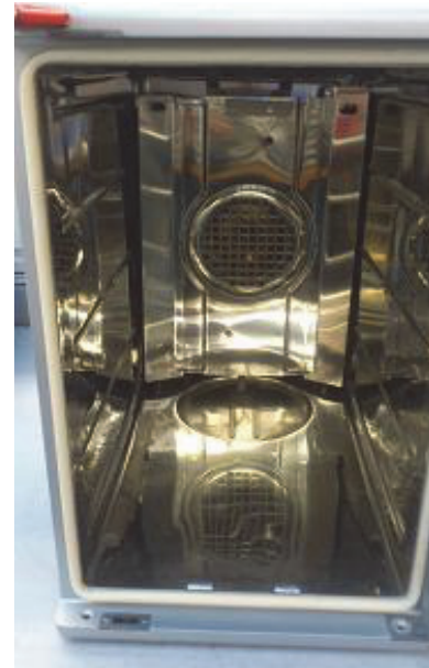
Abbildung 5: Ofen mit geschütztem Heizelement.
