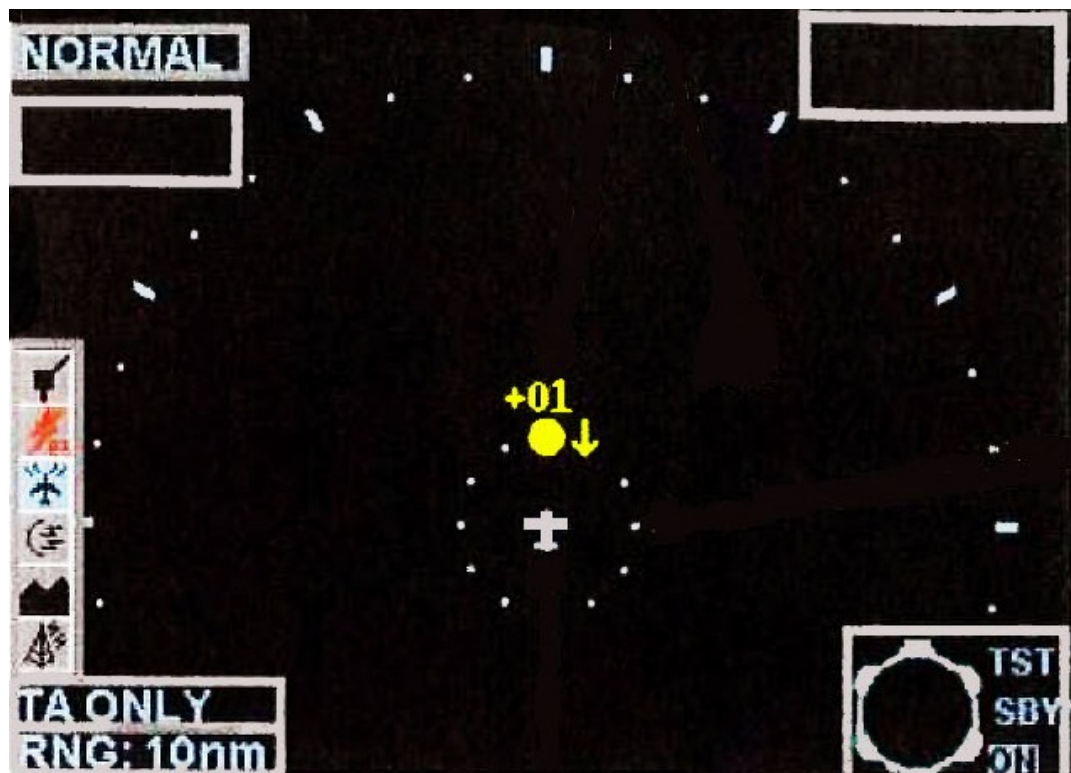
Abbildung 2: Darstellung einer traffic advisory (TA) im Multi-Function Display KMD 850. Das gelb dargestellte Luftfahrzeug ( intruder ) weist eine um 100 ft höher liegende Flughöhe auf, angedeutet durch den Wert „+01“. Der nach unten gerichtete Pfeil rechts des gelben Punktes deutet auf eine Sinkrate von mindestens 500 ft /min hin.
