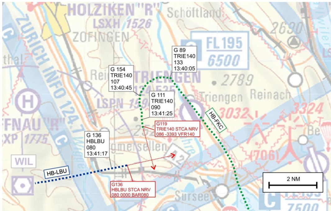
Abbildung 1: Überblick über die Flugwege der beiden Flugzeuge HB-LBU und HB-FKC bis zur erstmaligen Auslösung des STCA. Die Radaretiketten bestehen aus 4 Zeilen, die folgende Informationen enthalten: 1. Zeile: Geschwindigkeit über Grund in Knoten; 2. Zeile: Funkrufzeichen oder Radarbezeichnung; 3. Zeile: Flughöhe in Hektofuss; 4. Zeile: Zeit in UTC. Die Luftfahrtkarte ICAO 2013 von Swisstopo wurde als Basis verwendet.
