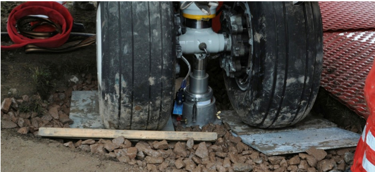
Abbildung 22: Rechtes Hauptfahrwerk. Heben des Fahrwerks und Einlegen einer harten Unterlage
