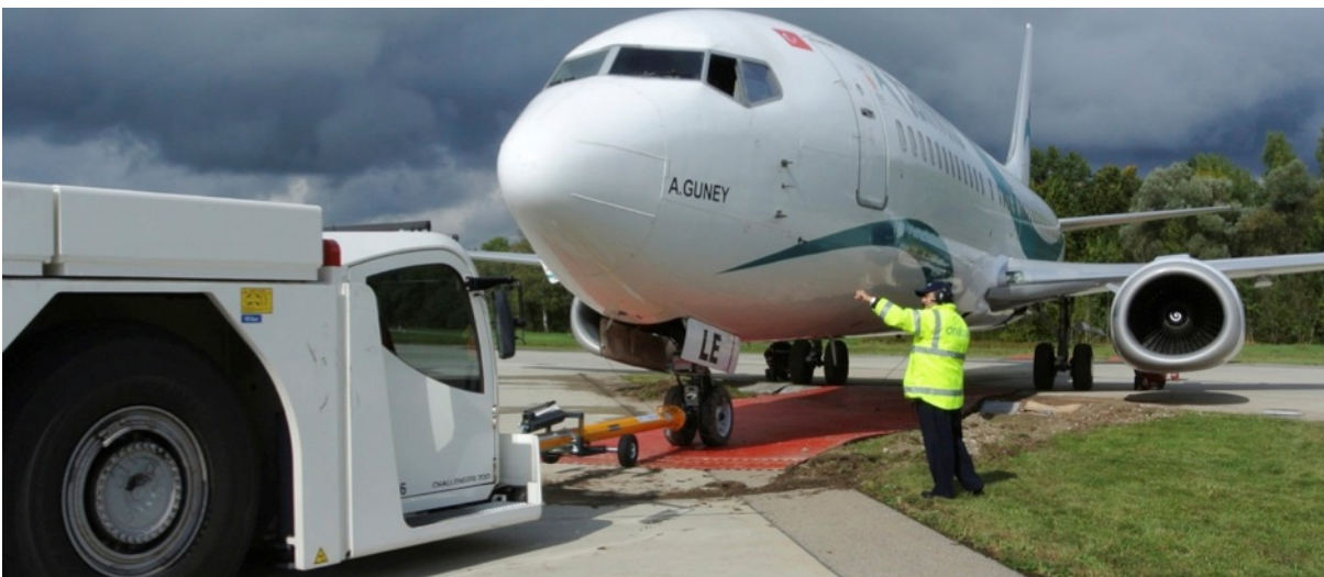
Abbildung 23: Blickrichtung Norden, Zurückstossen des Flugzeuges mittels Traktor und towbar , Traktor auf de-icing lane F2
