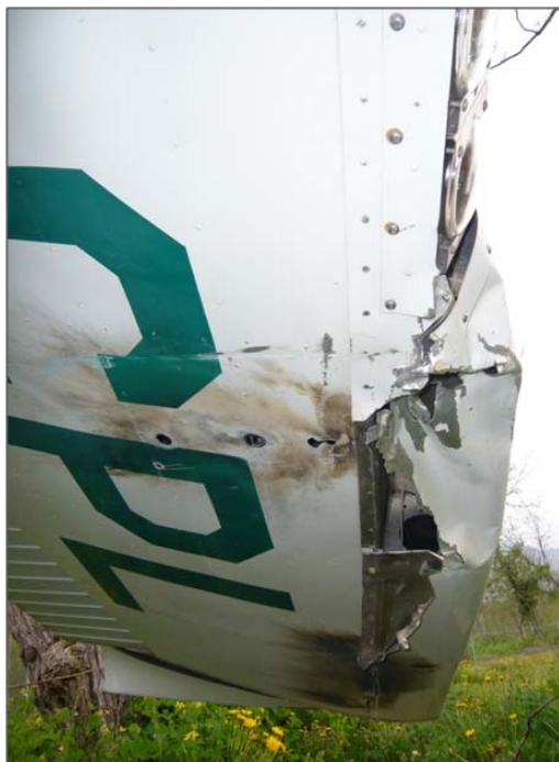
Fig. 5 : Perforations de l'intrados gauche
