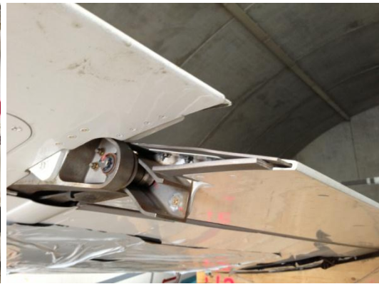
Abbildung 25: Klappen am linken Flügel, 9.49° ausgefahren
