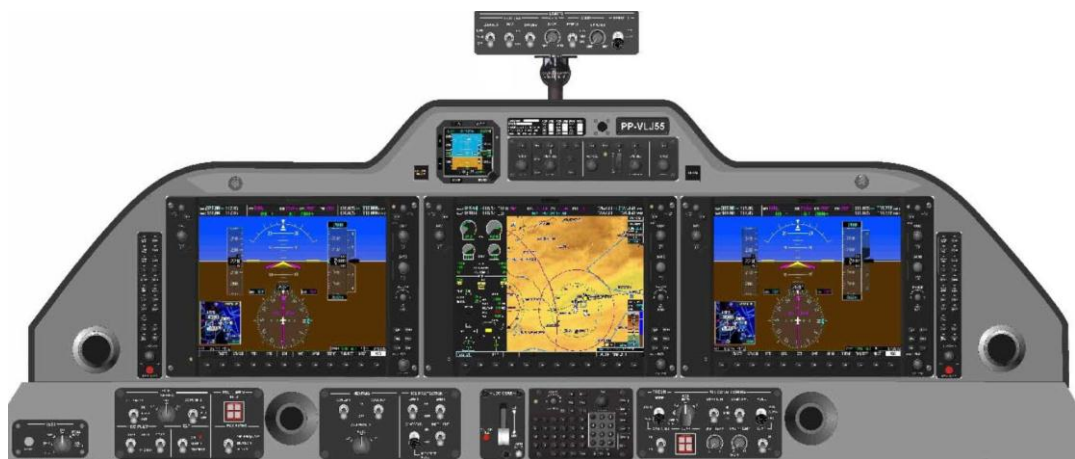
Abbildung 1: Übersicht Cockpit-Frontpaneele mit der Bildschirmwahl wie sie für den Normalfall ( normal operation ) gewählt wird: links und rechts je ein primary flight display (PFD) und in der Mitte ein multifunction display (MFD)
