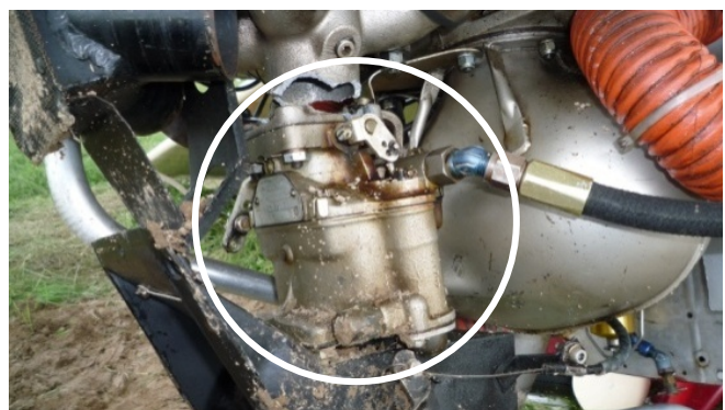
Abbildung 3: Der Vergaser ist vorne und unter dem Motor montiert.
