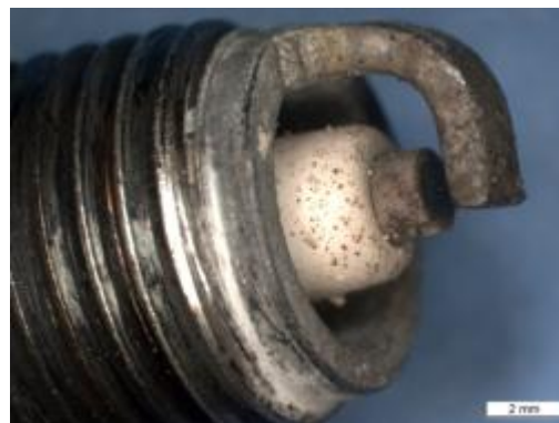
Fig. 6: Electrodes de la bougie supérieure du cylindre no. 2
