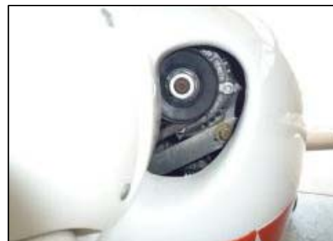
Fig. 3: Côté gauche – entrée d'air des cylindres no. 2 et no. 4 avec le kit alternateur supplémentaire
