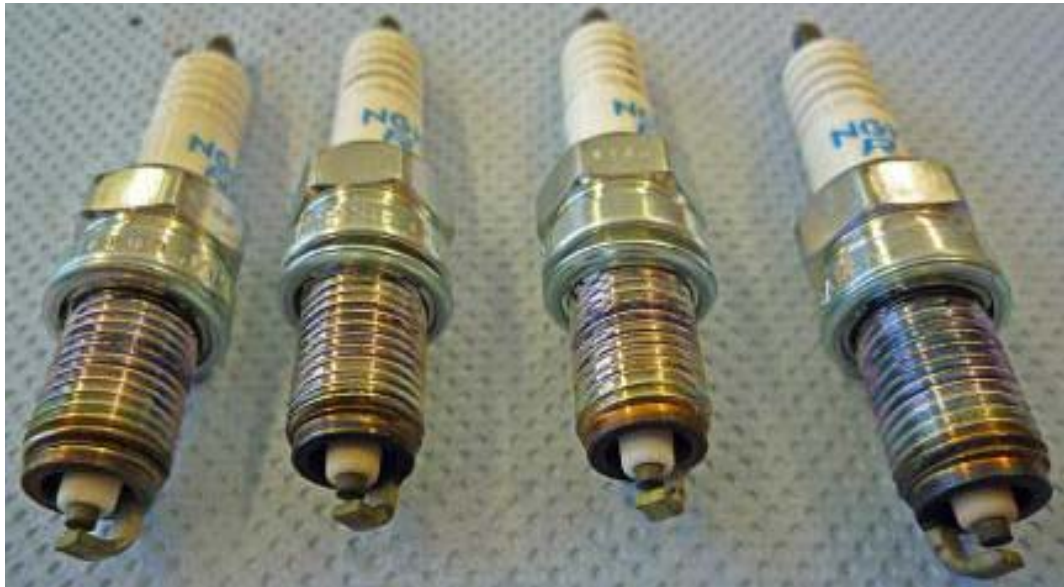
Fig. 8: Vue des 4 bougies inférieures après les tests du moteur au banc d'essai
