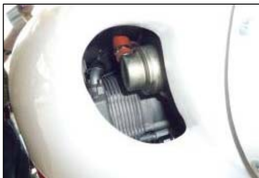
Fig. 2: Côté droit – entrée d'air des cylindres no. 1 et no. 3
