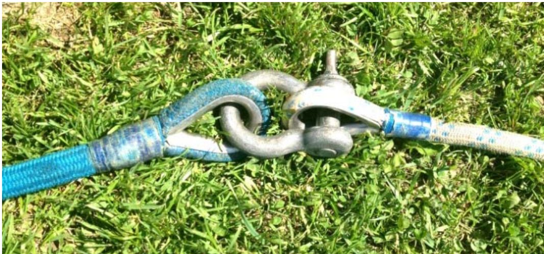
Abbildung 1: Metallschäkel als Verbindungsstück der beiden verwendeten Lastleinen
