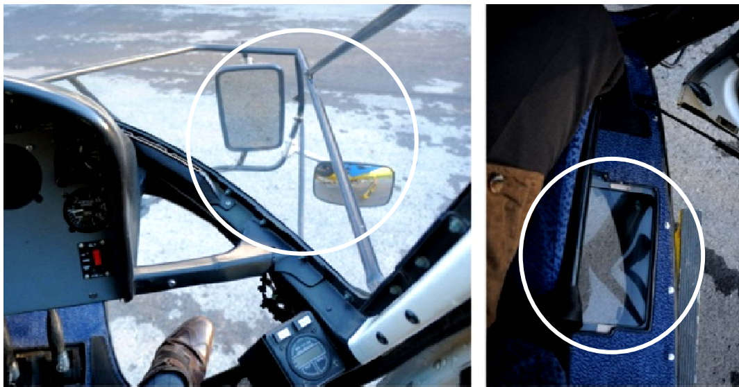
Abbildung 3: Bild links : Anordnung der Lastenspiegel / Bild rechts : Bodenluke
