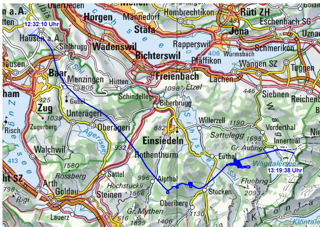
Abbildung 1: Darstellung des Flugweges der HB-2331, basierend auf den Daten des Loggers.
