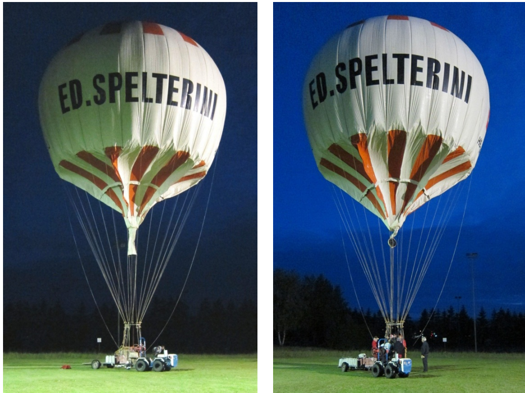
Abbildung 1: Der Ballon kurz vor dem Start. Deutlich sichtbar die nicht vollständig gefüllte Hülle. Der Füllansatz (Appendix) am unteren Ende der Hülle ist auf dem linken Bild offen, auf dem rechten, welches etwas später aufgenommen wurde, teilweise hochgezogen, d.h. der untere Holzring (Pöschelring) ist um ungefähr 90 Grad gedreht.
