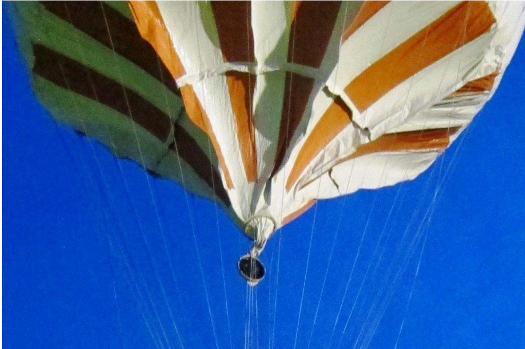
Abbildung 3: Vergrößerter Ausschnitt der Abbildung 2, welcher den Füllansatz (Appendix) zeigt. Der untere Holzring (Pöschelring) ist um ungefähr 90 Grad gedreht.
