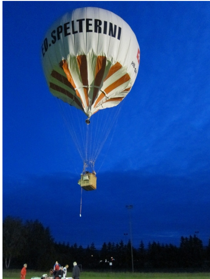
Abbildung 2: Der Ballon kurz nach dem Start. Der Füllansatz (Appendix) ist teilweise hochgezogen.
