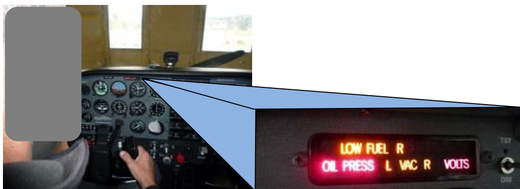
Abbildung 1: Position des warning display im Cockpit des Flugzeuges. Die Vergrößerung zeigt die Hinweisschrift LOW FUEL R , die bei einem geringen Treibstoffstand im rechten Tank angezeigt wird.
