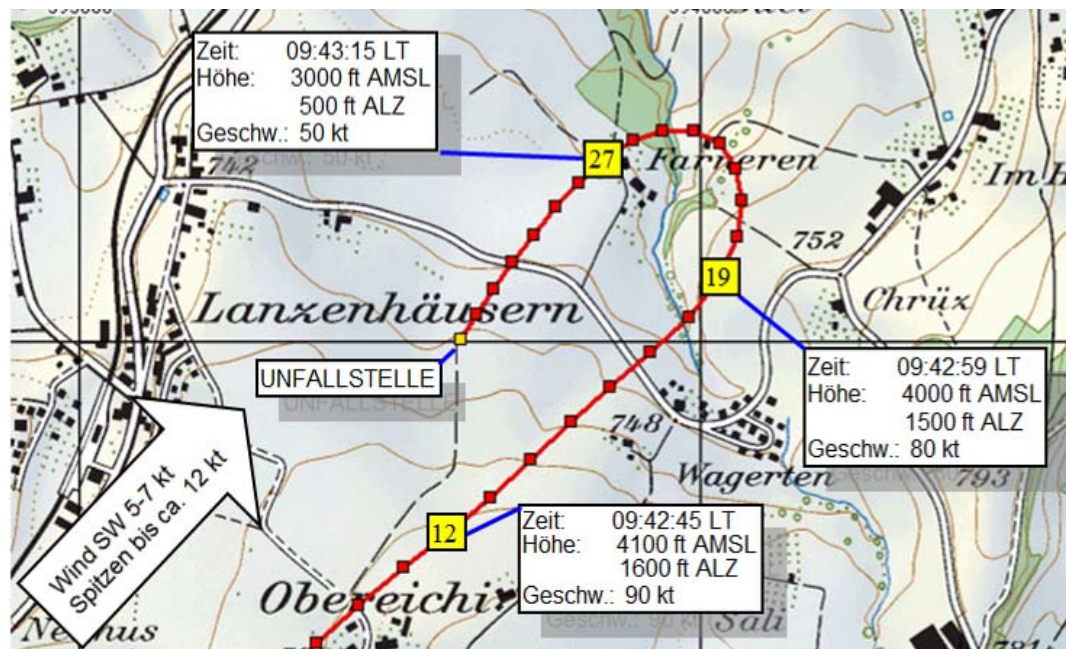
Abbildung 1: Flugweg in der Endphase. Die Daten wurden im Zwei-Sekunden-Intervall aufgezeichnet. ALZ entspricht der Höhe über dem vorgesehenen Landeplatz. Die angegebenen Geschwindigkeiten entsprechen der Geschwindigkeit über Grund.
