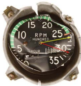
Fig. 6 : Compte-tours – RPM Indicator . Des impacts de l'aiguille sont détectés depuis 2800 RPM, flèche jaune. La flèche rouge indique 3200 RPM, le nombre de tours maximum atteint.
