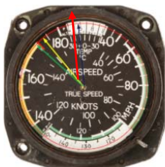
Fig. 5 : Indicateur de vitesse – Airspeed Indicator . La flèche jaune indique 173 MPH, la flèche verte 170 MPH et la flèche rouge indique 188 MPH, la vitesse maximale atteinte.
