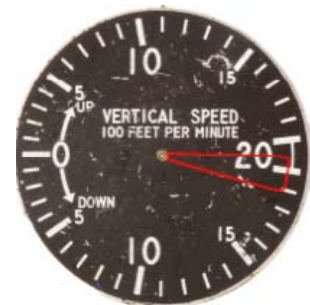
Fig. 7 : Variomètre – Vertical Speed . Le triangle rouge indique 1900 à 2000 ft/min DOWN , le secteur des impacts relevé sur l'instrument.
