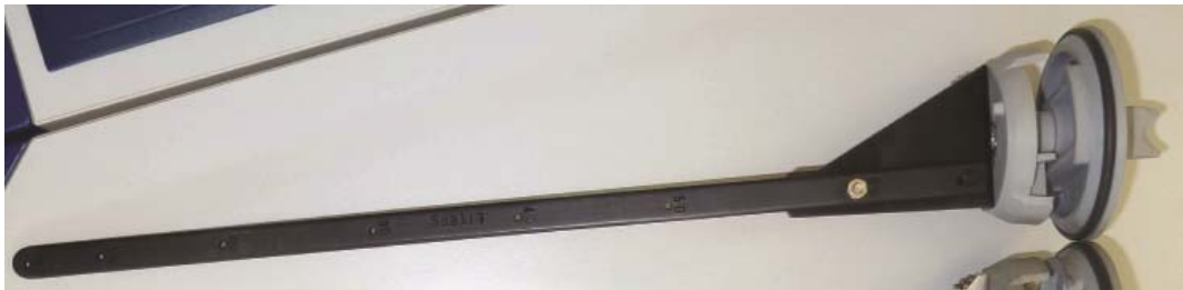
Abbildung 6: Messstab mit Skalierung bis 65 Liter
