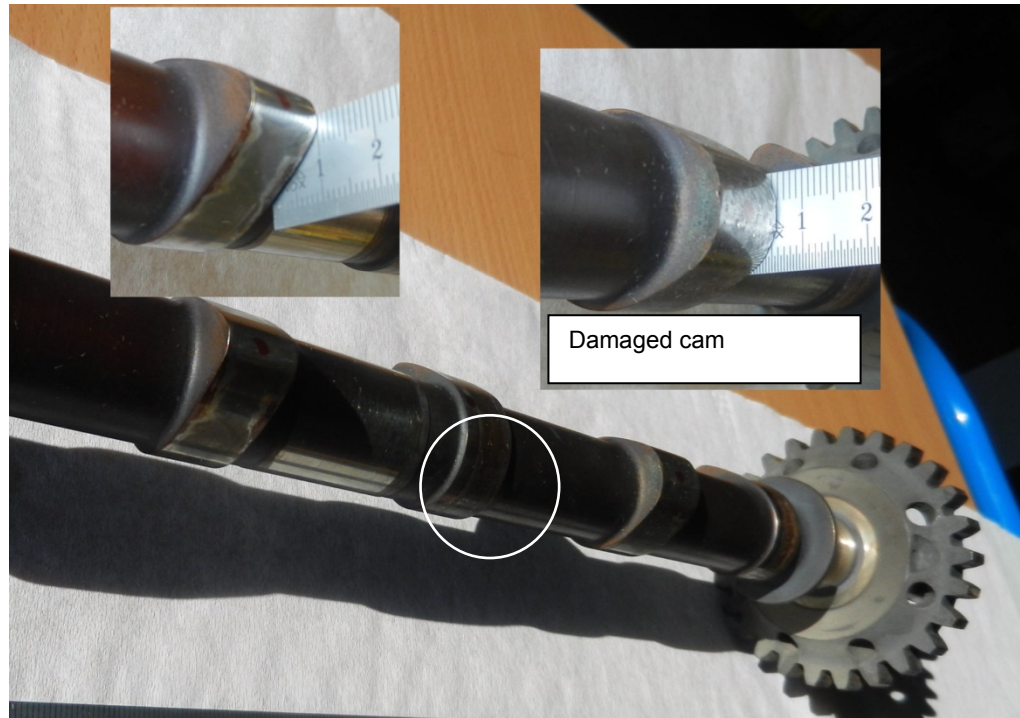
Figure 4: Camshaft with damaged cam (beschädigter Nocken=Damaged cam)
