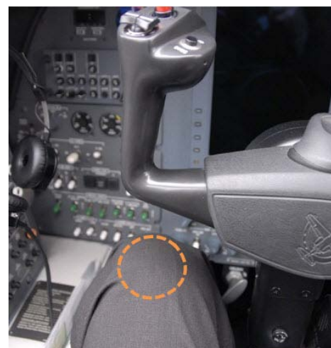
Abbildung 4: Der Betätigungshebel der Feststellbremse wird durch das linke Knie des Kommandanten verdeckt.
