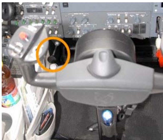
Abbildung 3: Der Betätigungshebel für die Feststellbremse ( parking brake ) befindet sich links von der Steuersäule des Kommandanten (orange eingekreist).
