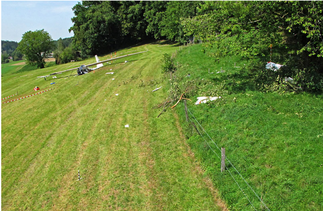
Abbildung 3: Unfallstelle in Flugrichtung betrachtet. Die Kollision des rechten Flügels fand mit den Bäumen, sichtbar am oberen rechten Bildrand, statt.
