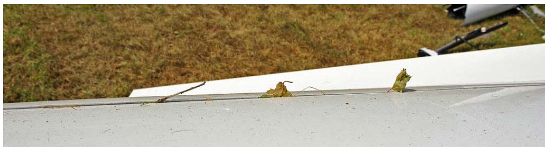
Abbildung 1: Bremsklappe des rechten Flügels mit darunter eingeklemmtem Zweig und Blättern.
