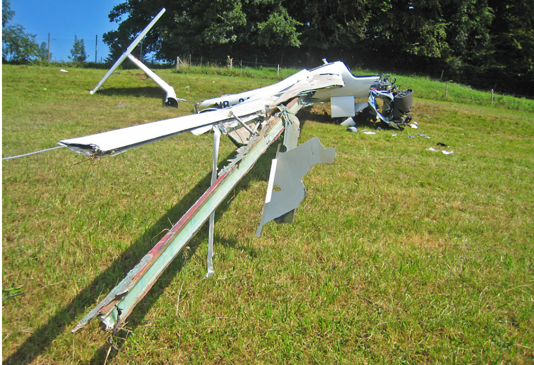
Abbildung 2: Wrack in der Endlage. Im Vordergrund der rechte Flügel. Der rechte Flügel war anfänglich mit Bäumen des kleinen Wäldchens im Hintergrund kollidiert. Der Kollisionsspunkt mit den Bäumen befindet sich weiter rechts des Bildes.
