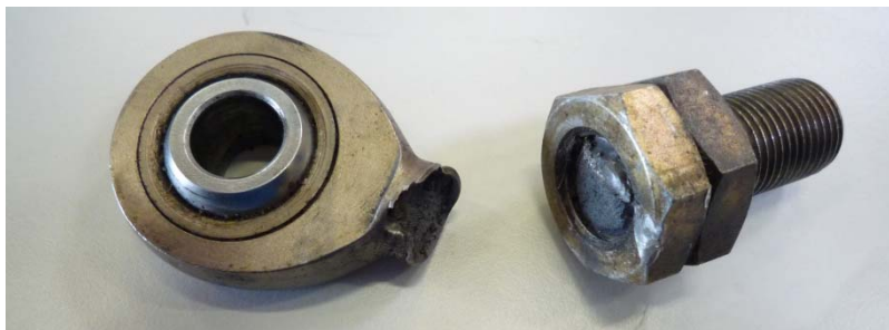
Fig. 4: Rotule de fixation - rod end bearing du vérin de rentrée et de sortie du train avant
