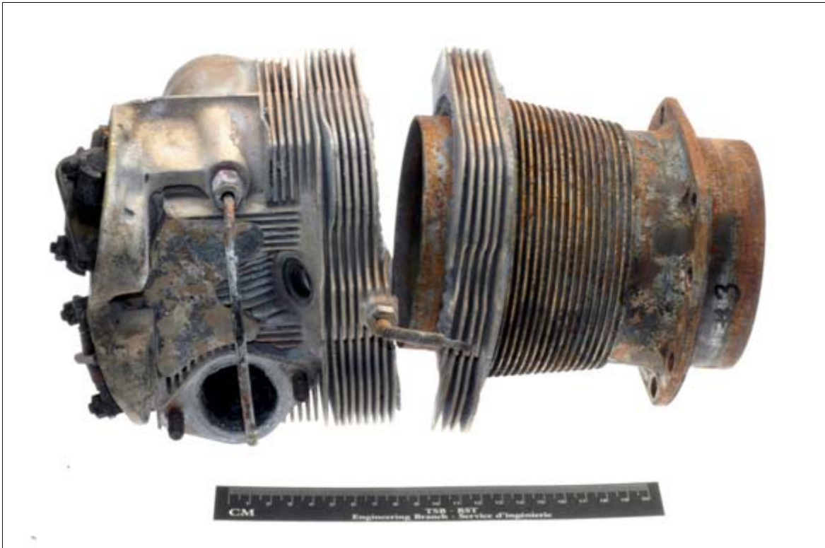
Figure 1. Le cylindre numéro 3 déposé du moteur
