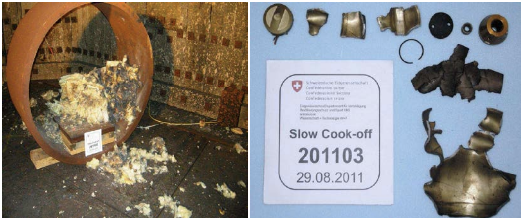
Abbildung 12: Resultat des Tests und Fragmente
