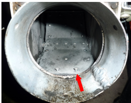
Abbildungen 4 und 5: Klappe Vergaservorwärmung im ein- und ausgebauten Zustand
