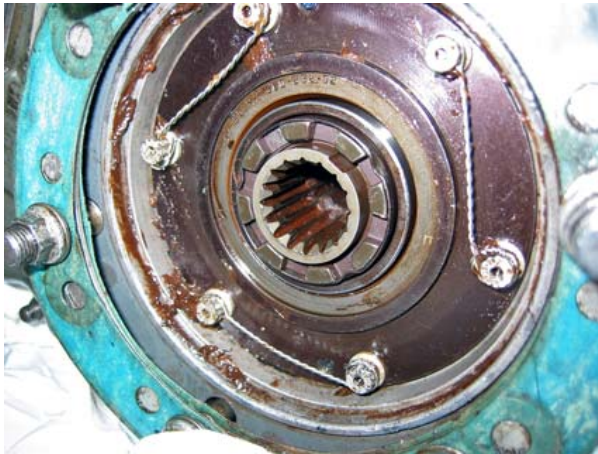
Bild 6 - Starter/Generator Anbaustelle an der N1 accessory drive gearbox
