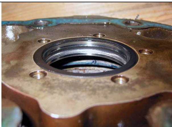
Bild 10 - Lagerausserenring mit Spurrillen
