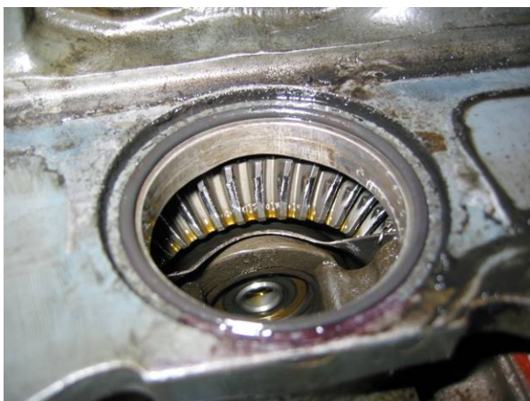
Bild 7 - Blick auf defektes accessory drive gear assembly
