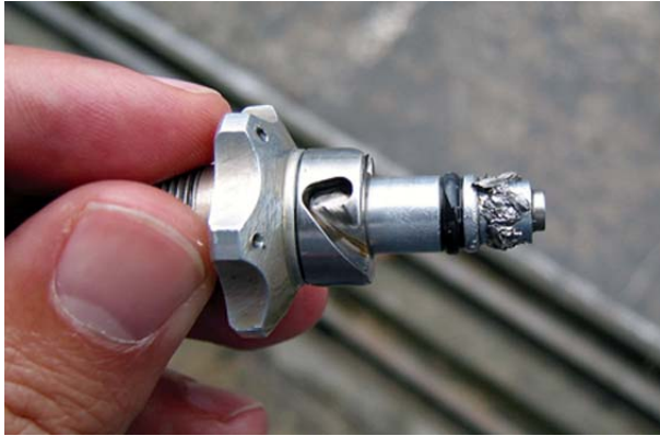
Bild 5 - Magnetzapfen des Triebwerkes mit Spänen
