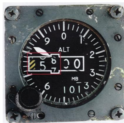
Abbildung 5: *standby altimeter*
