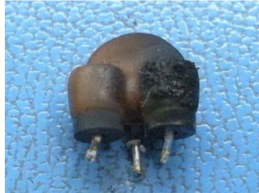
Fig. 9: Inducteur FL2 endommagé
