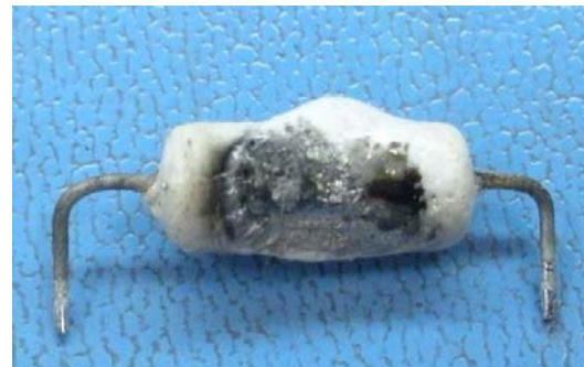
Fig. 7: Condensateur R7 endommagé
