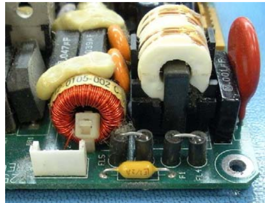
Fig. 5: La position F1 montre l'installation du fusible calibré à ½ Amp.
