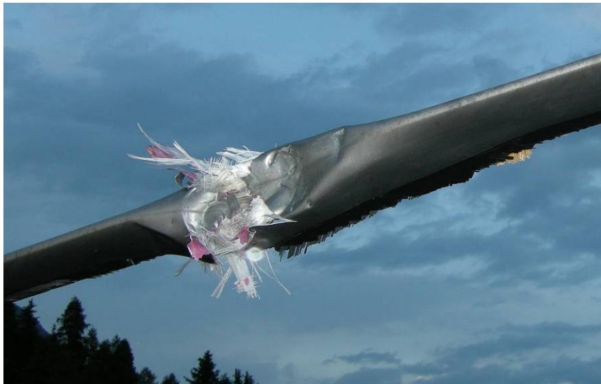
Bild 8: Verformungen an der Metall-Vorderkante des zerstörten Rotorblattes
