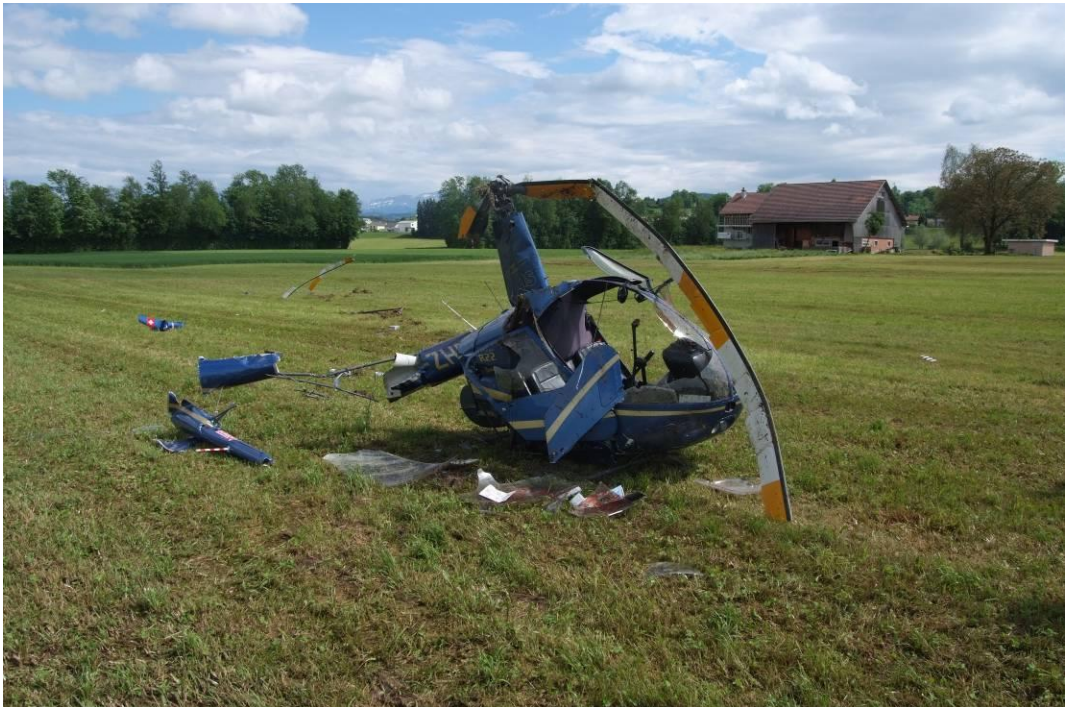
Abbildung 1: Hauptwrack des Helikopters nach dem Unfall. Der Helikopter wurde nach dem Unfall aufgerichtet, um das weitere Auslaufen von Betriebsstoffen zu verhindern. Im Hintergrund weitere Einzelteile sowie verschiedene Einschlagspuren, welche die Anflugrichtung erkennen lassen (ungefähr entgegen der Blickrichtung).
