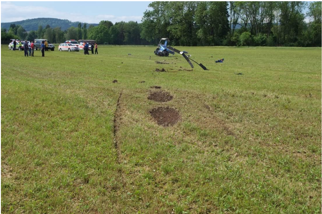
Abbildung 2: Im Vordergrund die ersten Einschlagspuren der Kufen und der Rumpfunterseite, weiter hinten eines der beiden Hauptrotorblätter, welches abgerissen wurde und im Boden steckte, ganz hinten das Hauptwrack.
