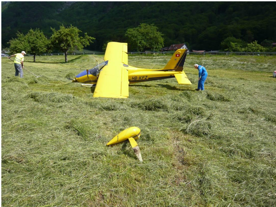
Abbildung 1: Endlage des Flugzeuges nach dem Unfall, aufgenommen am Folgetag. Im Vordergrund das abgerissene linke Hauptfahrwerk und Spuren vom Fahrwerk im Boden, welche die Richtung des Aufsetzens erkennen lassen (ungefähr in Blickrichtung).
