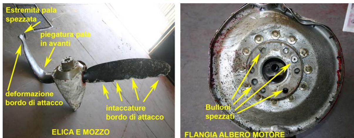
Foto n. 12: danneggiamenti sull’elica.
