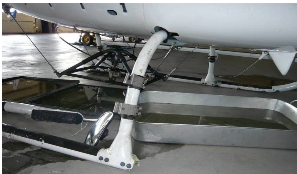
Fig. 3: Point de rupture du patin avant droit
